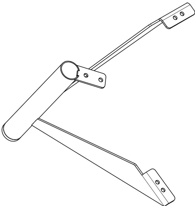
Материал: Сталь 08пс 3 мм, труба d=32 мм 1,5 мм,
