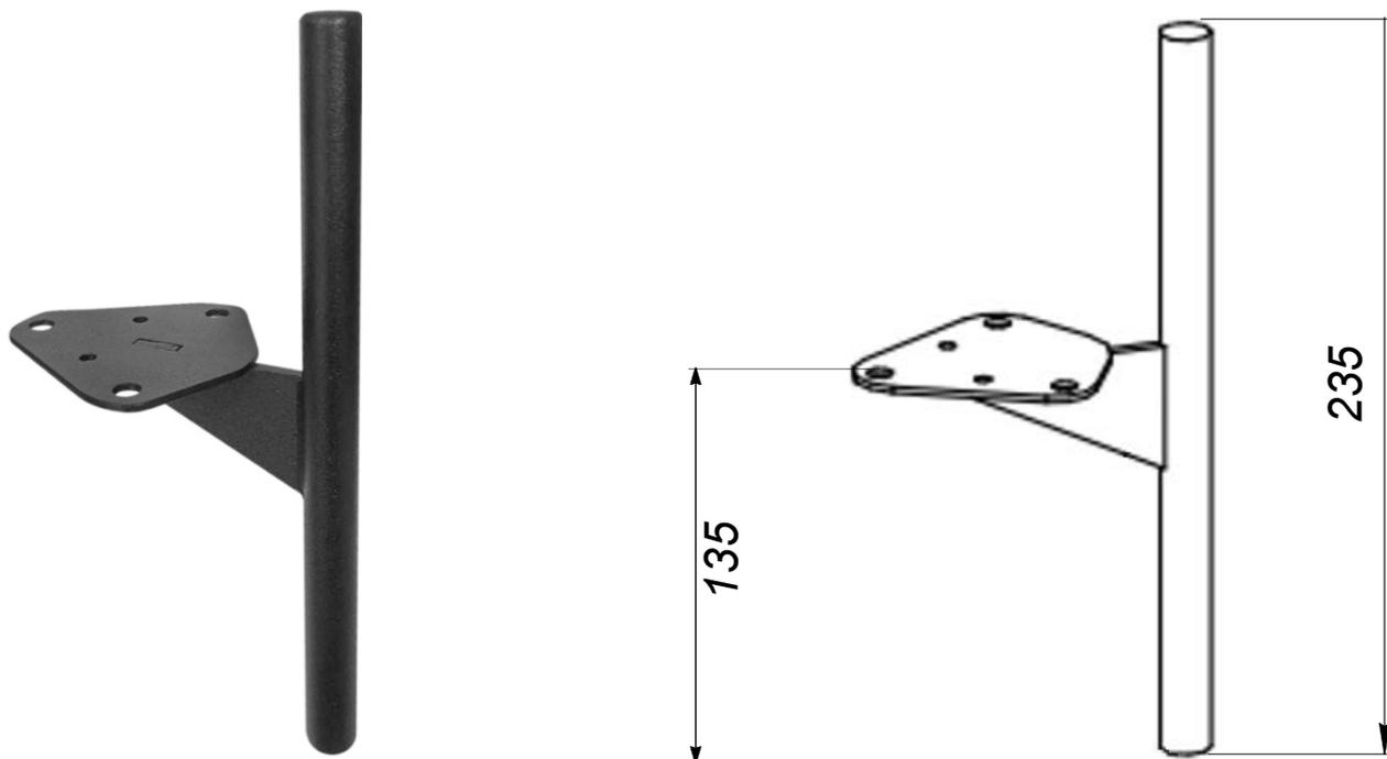
Материал: Сталь 08пс 3 мм, труба d=16 мм 1,2 мм,
