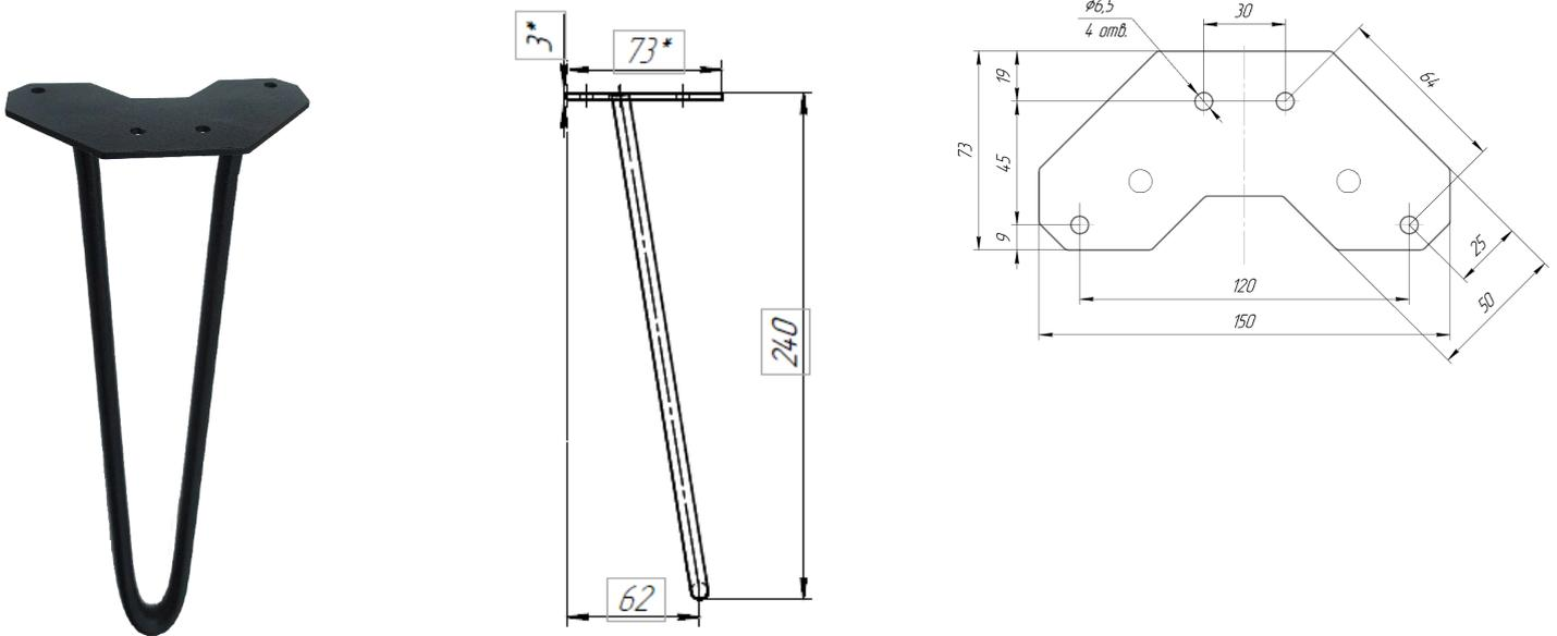
Материал: Сталь 08пс 3 мм, пруток стальной 8 мм
