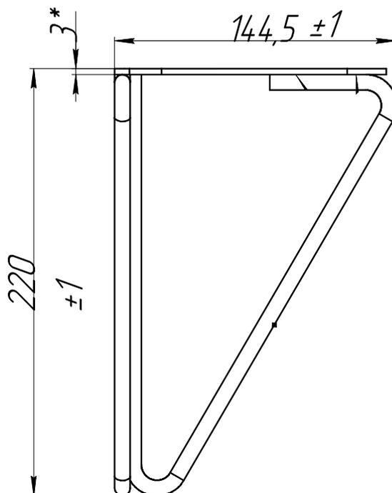
Материал: Сталь 08пс 3 мм, пруток стальной 8 мм
