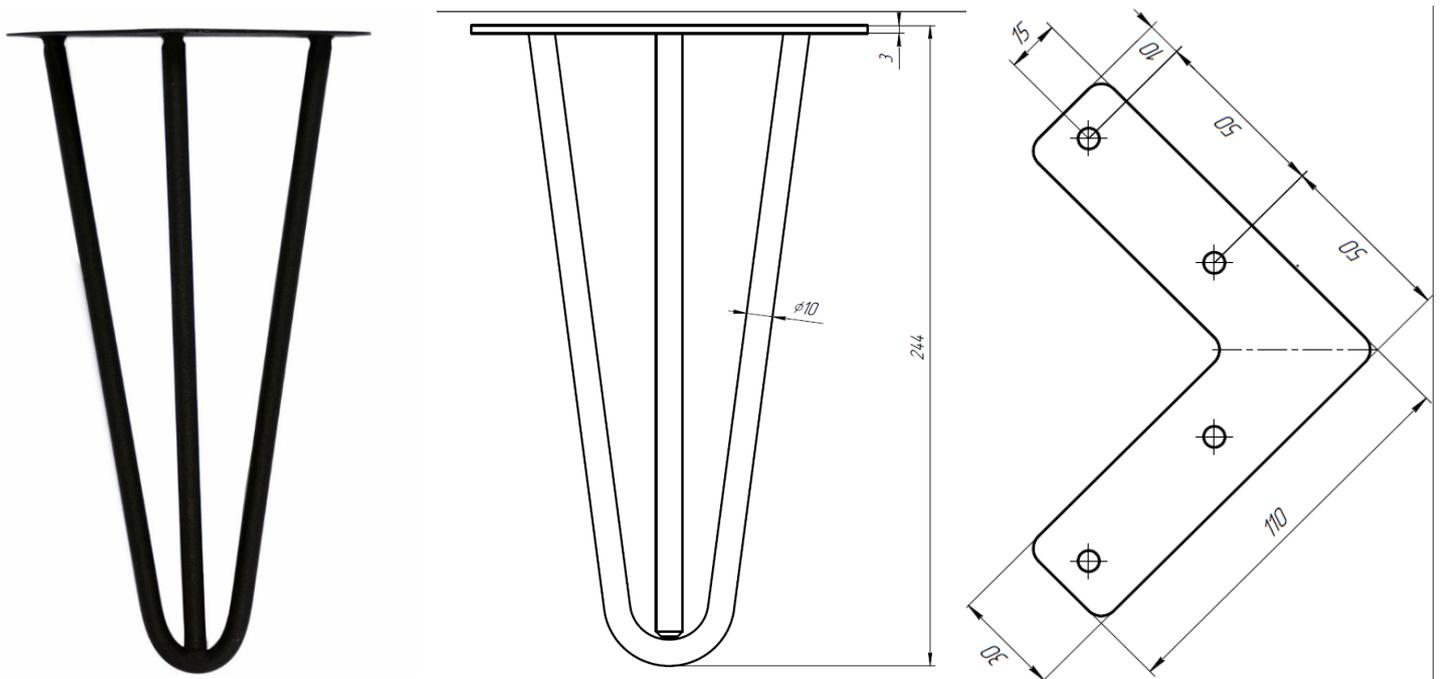
Материал: Сталь 08пс 3 мм, пруток стальной 10 мм
